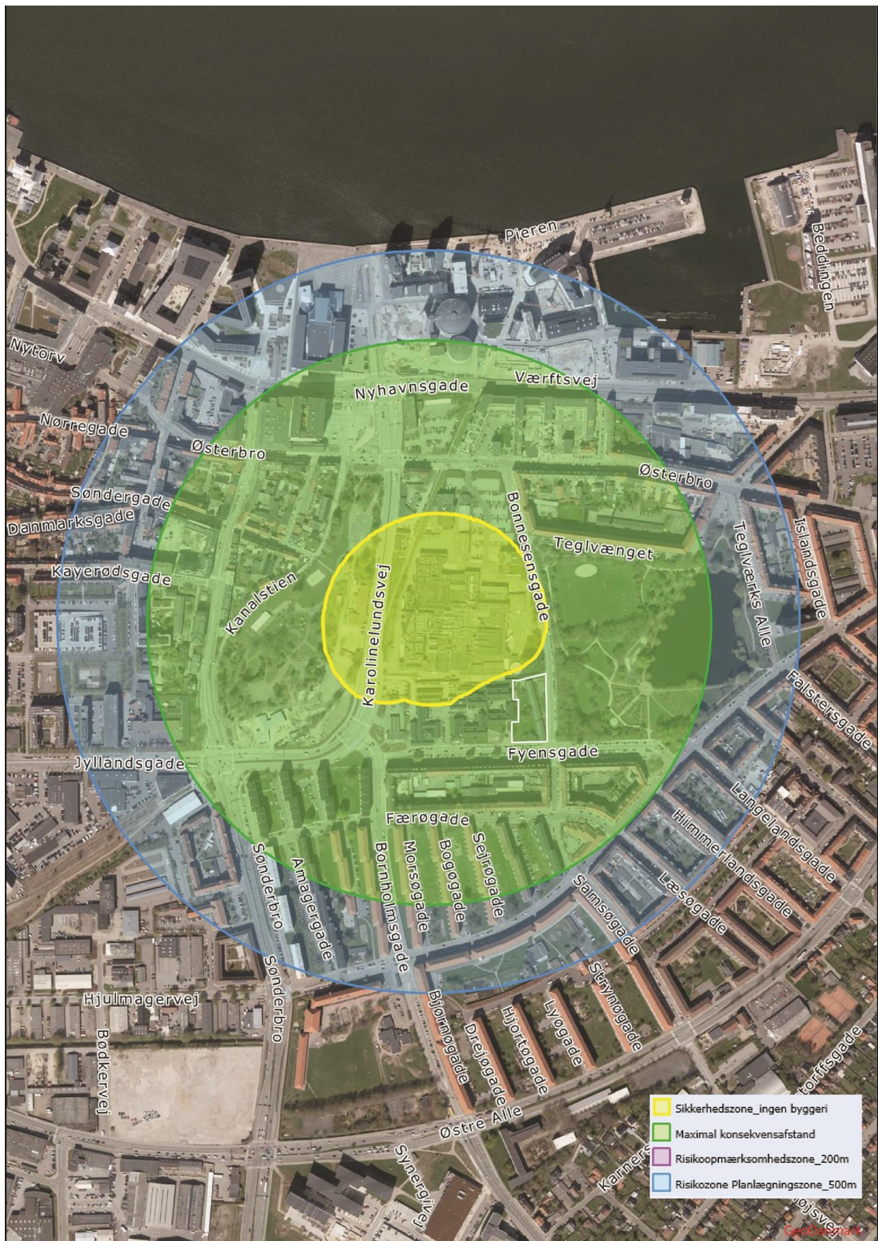
Figuren viser de planlægningsmæssige afstande til Tulip Food Company, hvoraf den gule kurve viser sikkerhedsafstanden og den grønne kurve viser konsekvensafstanden.
