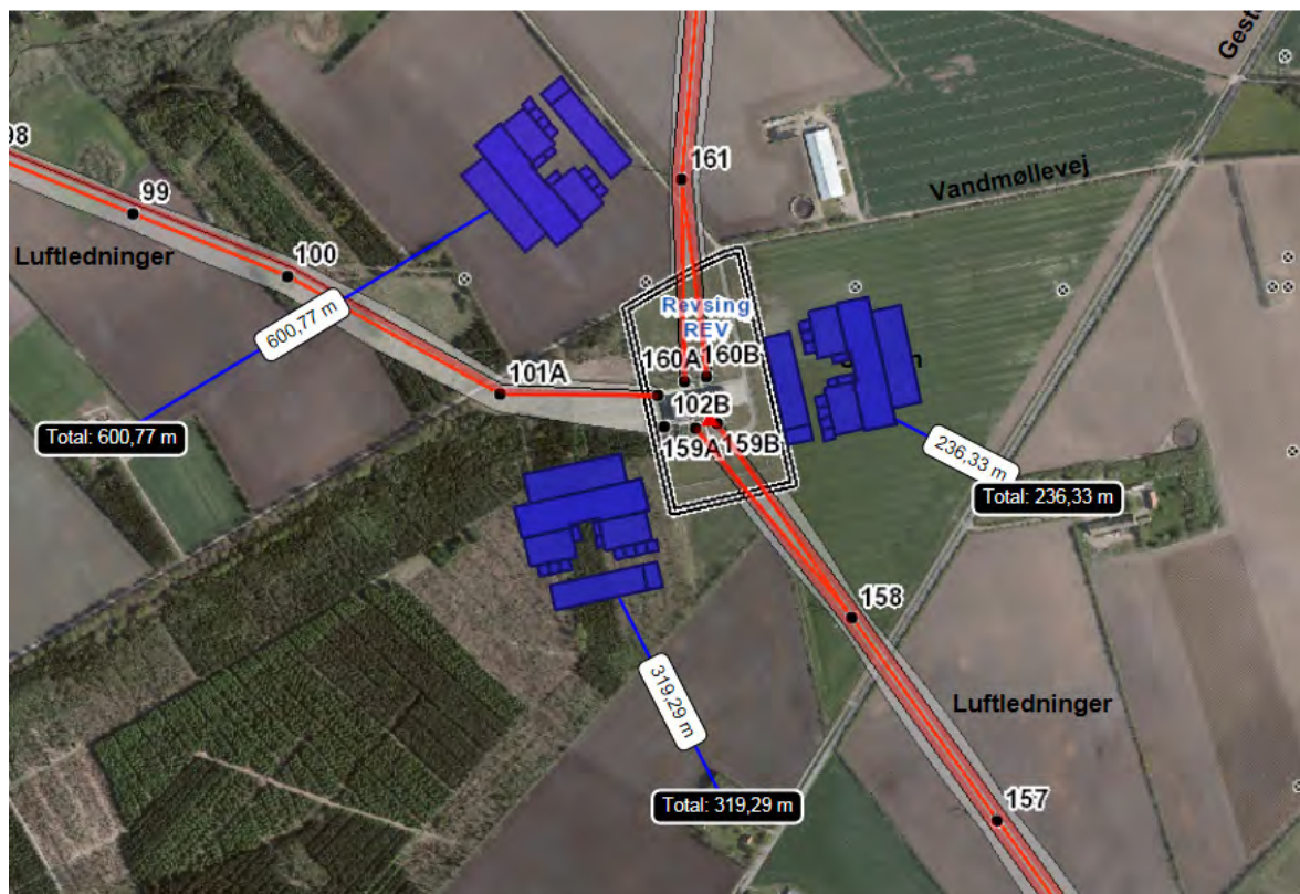
Figur 9 Afstand til nærmeste beboelser i de 3 alternative placeringer af omformerstationen.
