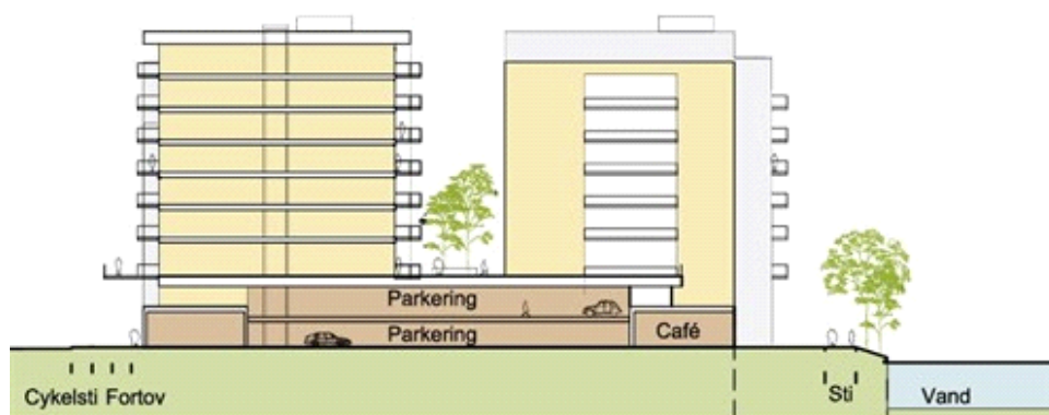
Snit, som viser de to parkeringsdæk i den nordligste del af bygningsbasen samt punkthusene ovenpå bygningsbasen.
