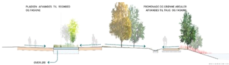
Princip for håndtering af regnvand på promenaden.
